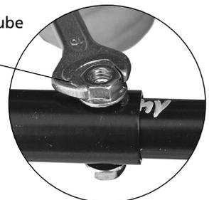
Legen Sie die Ausgleichswelle auf beiden Seiten in die runde Aussparung des Rahmenkastens ein. Die Schrauben am Ende der Ausgleichswelle zeigen dabei nach oben, die Muttern nach unten.
