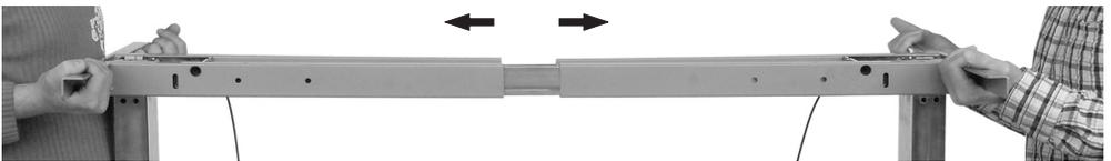
Ziehen Sie jetzt das Tischgestell an den beiden Querstangen auf die gewünschte Breite auseinander oder zusammen. Achten Sie darauf, dass die Schiebestangen anhand der eigekehrten Markierungen „Mitte“ ausgemittelt bleiben (siehe Skizze unten). Der maximale Ausziehbereich darf nicht überschritten werden.
