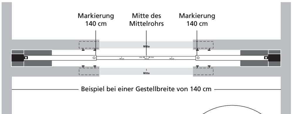
Um das auf die Breite eingestellte Gestell zu fixieren, müssen die Stiftschrauben an den Querstangen mit dem Innensechskantschlüssel angezogen werden.
