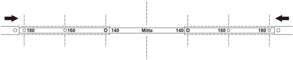
Auf dem Mittelrohr befinden sich Maßangaben und Bohrungen. Mitteln Sie das Mittelrohr aus und passen Sie die beiden Außenrohre mit Hilfe der Maßangaben auf das Maß der Gestellbreite an. Tarieren Sie die Röhren so aus, dass die Bohrungen aufeinander passen. Führen Sie die selbstschneidenden Schrauben M6x25 durch die Bohrungen und drehen Sie diese mit dem 10er Gabelschlüssel ganz ein. Fixieren Sie die selbstschneidenden Schrauben auf der Unterseite mit den Muttern M6.
