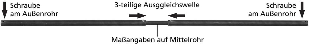
Verbinden Sie die 3 Röhren der Ausgleichswelle zu einer Stange. Die Schrauben an den beiden Außenrohren zeigen dabei nach oben.
