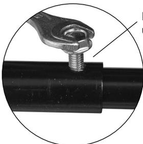
Eindrehen der selbstschneidenden Schraube und Fixierung mit der Mutter.
