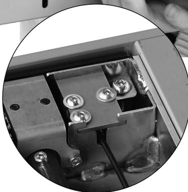
Fixieren Sie die Kabel mit der Gummimuffe an der Einsparung im Rahmenkasten.
