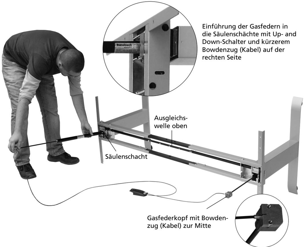
Nehmen Sie beide Gasfedern und führen Sie diese bis zum Anschlag in die beiden Gasfeder-Schächte am oberen Rahmenkasten ein. Achten Sie darauf, dass die Bowdenzüge (Kabel) an den Gasfederköpfen in Richtung Gestellmitte zeigen.
